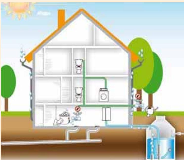
**Système de filtration des eaux grises pour injection dans le réseau des toilettes, de la machine à laver et du jardin**
