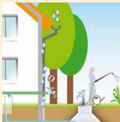
**Système de récupération des eaux de pluie avec injection dans un réseau spécifique pour les toilettes, la machine à laver et le jardin**
