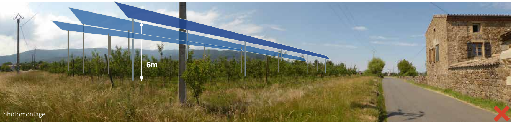
Simulation d'agrivoltaïsme à l'arrière du premier rang de fruitier ; la faible distance impacte fortement l'habitation adjacente.
